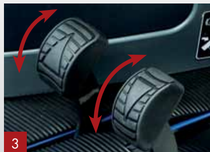
Komfortable 2-Pedal-Steuerung mit ergonomisch abgerundeten Pedalen.
