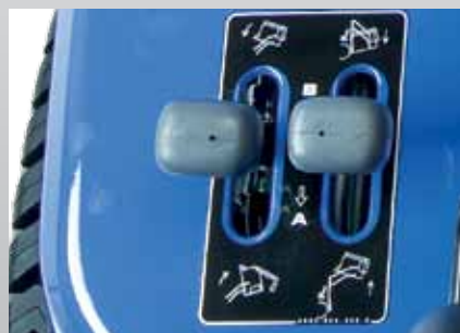
Steuerhebel zum Senken und Heben des Mähdecks (Foto links) sowie zur Betätigung des Sammelbehälters (Hochentleerung, Foto rechts).
