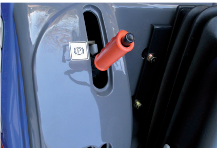
Der Handbremshebel ist in die Kulissee integriert. Für die Betätigung von bis zu 3 zusätzlichen Steuergerätefunktionen ist die Kulissee serienmäßig vorbereitet.
