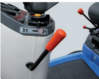
Zwei Allradmodi sind wählbar: Automatik oder Permanent
