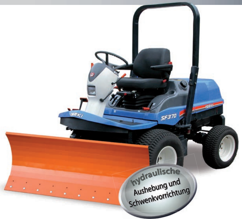
Das Schneeräumschild ist kurz an der Vorderachse angebaut. So hat der Fahrer es im direkten Blickfeld.
