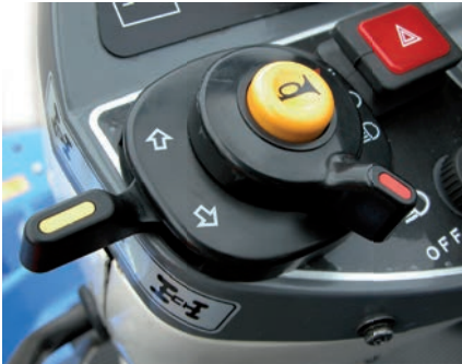
Kombi-Kontrollschalter der Beleuchtungsanlage
