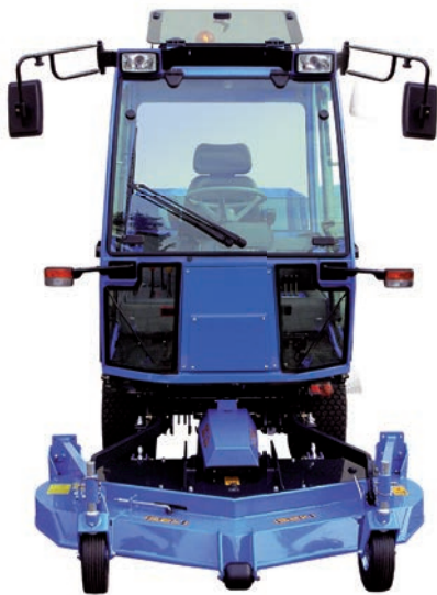
Heck- oder Seitenauswurfmäherwerke von 155 cm bis 183 cm Schnittbreite
