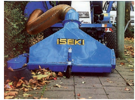
Spezial-Laubsaugeinrichtung mit integrierter Rotationsbürste
