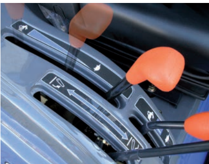
Einstellung der Fahrgruppen, der Mähwerksaushebung und des Tempomatens
