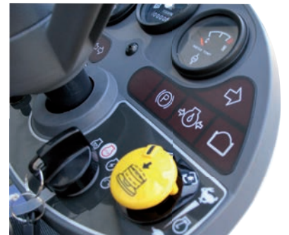
Lastschaltbare Zuschaltung der Zapfwelle. Inkl. Schnellstop-Funktion
