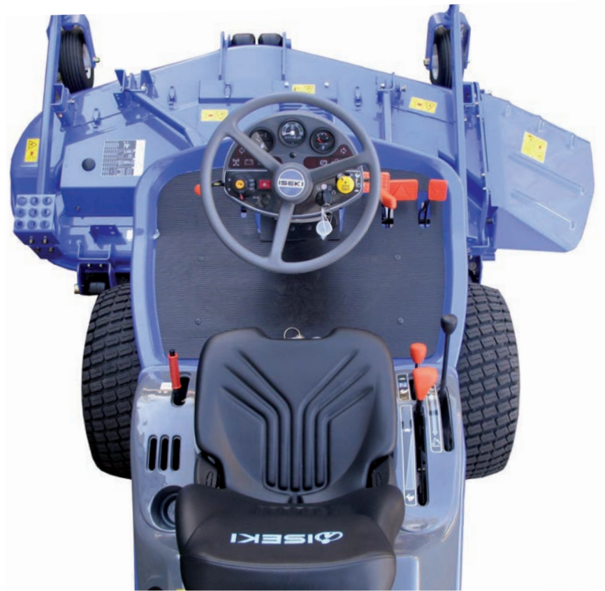
Lastschaltbare Zuschaltung der Zapfwelle. Inkl. Schnellstop-Funktion
