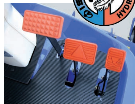
Durch zwei nebeneinander angeordnete Pedale wird der stufenlose, hydrostatische Fahrtrieb gesteuert.
