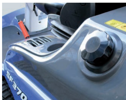
Der Kraftstofftank nimmt satte 50 Liter Diesel auf und kann auch bei aufgesatteltem Arbeitsgerät bequem von der Seite befüllt werden.
