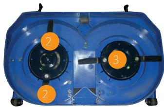
2. zwei separate Messerklingen, leicht und schnell wechselbar
