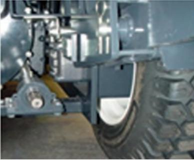
vollhydraulischer Antrieb vorn (Radmotoren)
