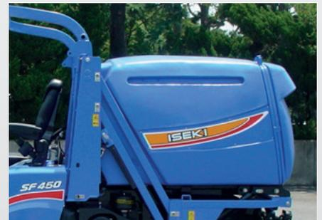
Optimal an die Grundmaschine angepasster Gras-/Laubsammelbehälter mit 1300 Litern Volumen.
