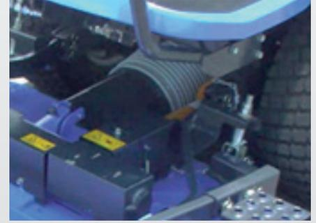
zentrale Grasaufnahme mit kurzem Saugschlauch
