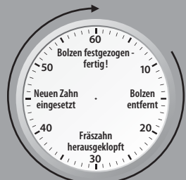
Austausch eines Fräszahns in nur 60 Sekunden möglich.
