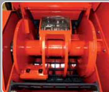
Hackrotor Durchmesser 600 mm mit 6 Hackmessern und großer Schwungmasse
