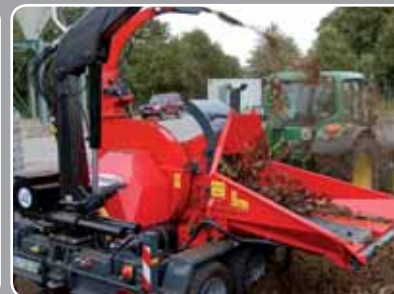
JT600 ausgestattet mit einem Förderband von 2300 mm Länge sowie mit einem Kran.
