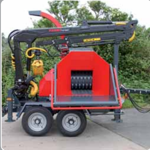
JT600 ausgestattet mit einem Kran.
