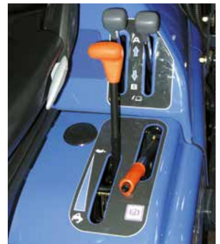
Der SFH 240 ist serienmäßig mit einem Tempomat zur stufenlosen Geschwindigkeitsfixierung und dem patentierten ISEKI-Leichtfahrssystem ausgestattet.
