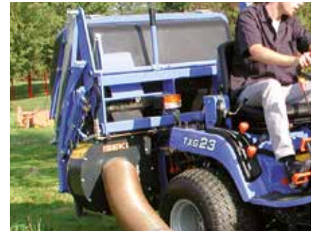
ISEKI-Grasaufnahmegерäte saugen das Gras zuverlässig durch große Stahlturbinen ab.
