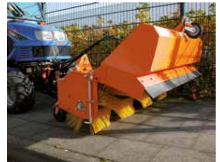
ISEKI-Frontkehrmaschinen mit einer Arbeitsbreite von 130 bis 150 cm können für den Ganzjahreseinsatz verwendet werden.
