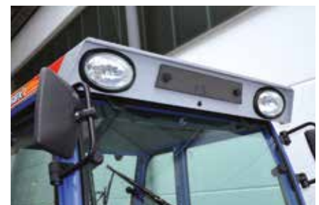
Im Dach integrierte Zusatzhauptscheinwerfer sorgen für eine optimale Ausleuchtung des Arbeitsbereiches - besonders im Wintereinsatz. Der Pollenfilter sorgt für saubere Luft im Kabineninneren.
