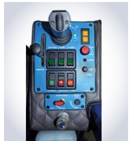
"Bestens begreifbar": Bedienerkonsole mit moderner Joystick-Steuerung. Intuitive Funktionsführung für z.B. Mähwerk, Besenanlage oder Schneeschild-Einsatz.
