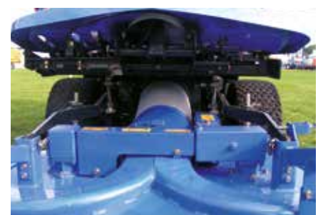
Kurzer Saugweg vom Mähwerk zur Absaugturbine.
