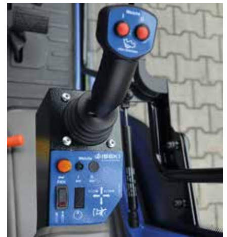
Option: Klappbare Armlehne mit elektrohydraulischer Steuerung – multifunktional, mit einer Hand bedienbar.
