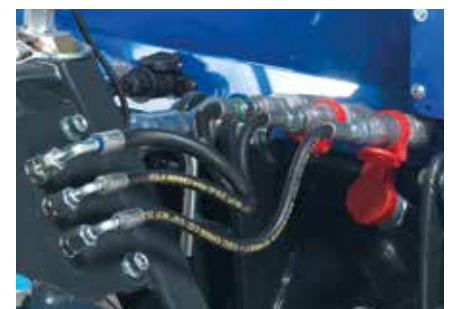
Flachdichtende und absolut tropfarme Hydraulikstecker.
