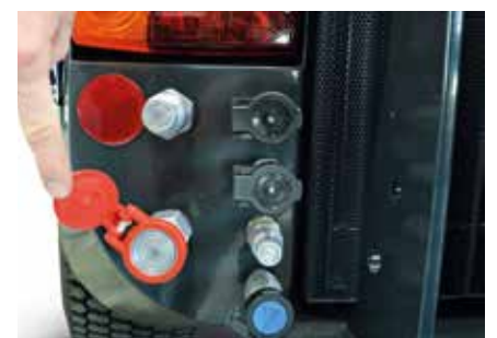
Die Heckhydraulikanschlüsse sind gut erreichbar angebracht.
