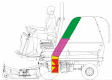
Eine zentrale Absaugturbine wird direkt (keilriemenfrei) von der Motorkurbelwelle angetrieben.
