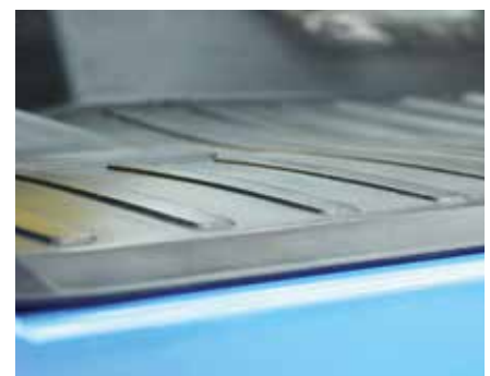
Die durchgehende Gummimatte dämmt den Kabineninnenraum gegen Lärm und Kälte und gewährleistet insbesondere im Wintereinsatz einen kontrollierten Wasserablauf (Reduzierung von Korrosion).
