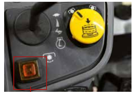
Separater Softanlaufschalter der Zapfwelle – bewährt aus den TG 5000er Modellen und einmalig in dieser Klasse.
