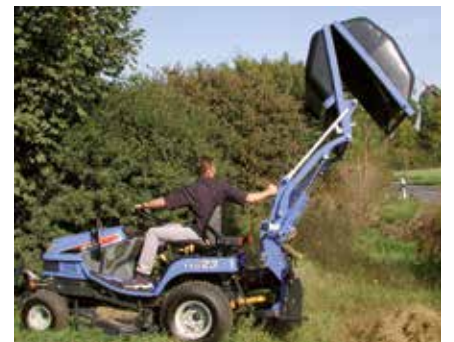
Die Hochentleerung GLS 500 mit einem 550-Liter-Grassammelbehälter und einer Entleerungshöhe von ca. 200 cm ist das ideale Gerät zur Grasaufnahme für Kompakt-Dieseltraktoren der 20 -24 PS Klasse.
