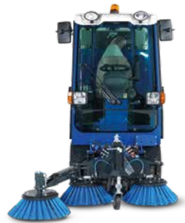
Mit Fahrzeugbreiten ab 100 cm passt der ISEKI-Geräteträger mit Knicklenkung durch (fast) alle Wege.
